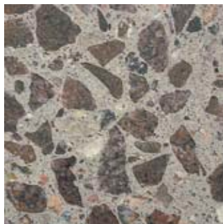
Polerad betong enligt HTC Superfloor™-konceptet i industriell miljö
