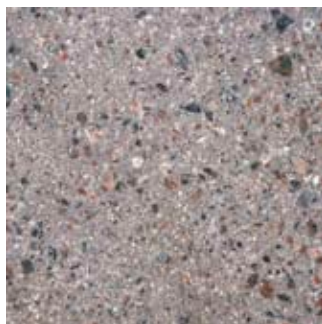
Exempel på variationer av pigmenterad cement och synlig ballast
